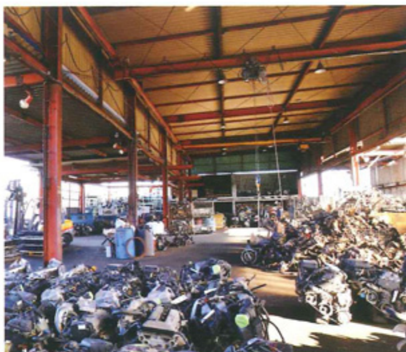
▲右はリビルト部品の生産現場の様相。素材のコアを集積している。リサイクル部品の生産は時間の経過とともに高度な水準に達している
