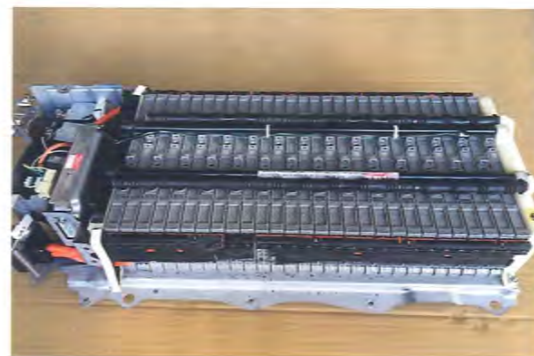
ニッケル水素バッテリーの再生前 (上部ケースを開けた状態)
